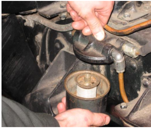
Рис. 9. Порядок очистки фільтра грубого очищення палива.
