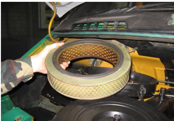
Рис. 11. Порядок обслуговування повітряного фільтра.
