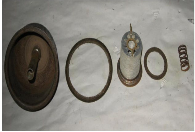
Рис. 9. Порядок очистки фільтра грубого очищення палива.
