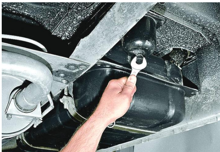
Рис. 5. Порядок зливу відстою з фільтра грубої очистки палива.
