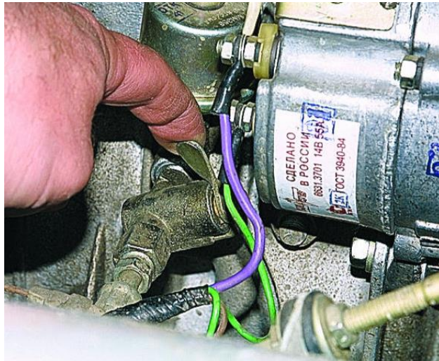
Рис. 9. Кран включення масляного радіатора.
