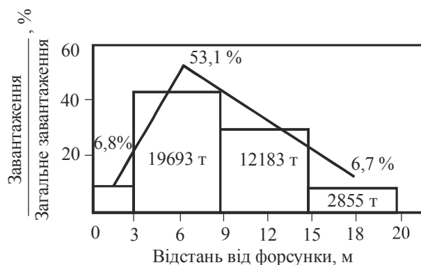
Рисунок 4.8 – Діаграма плавлення шихти по довжині відбивної печі
