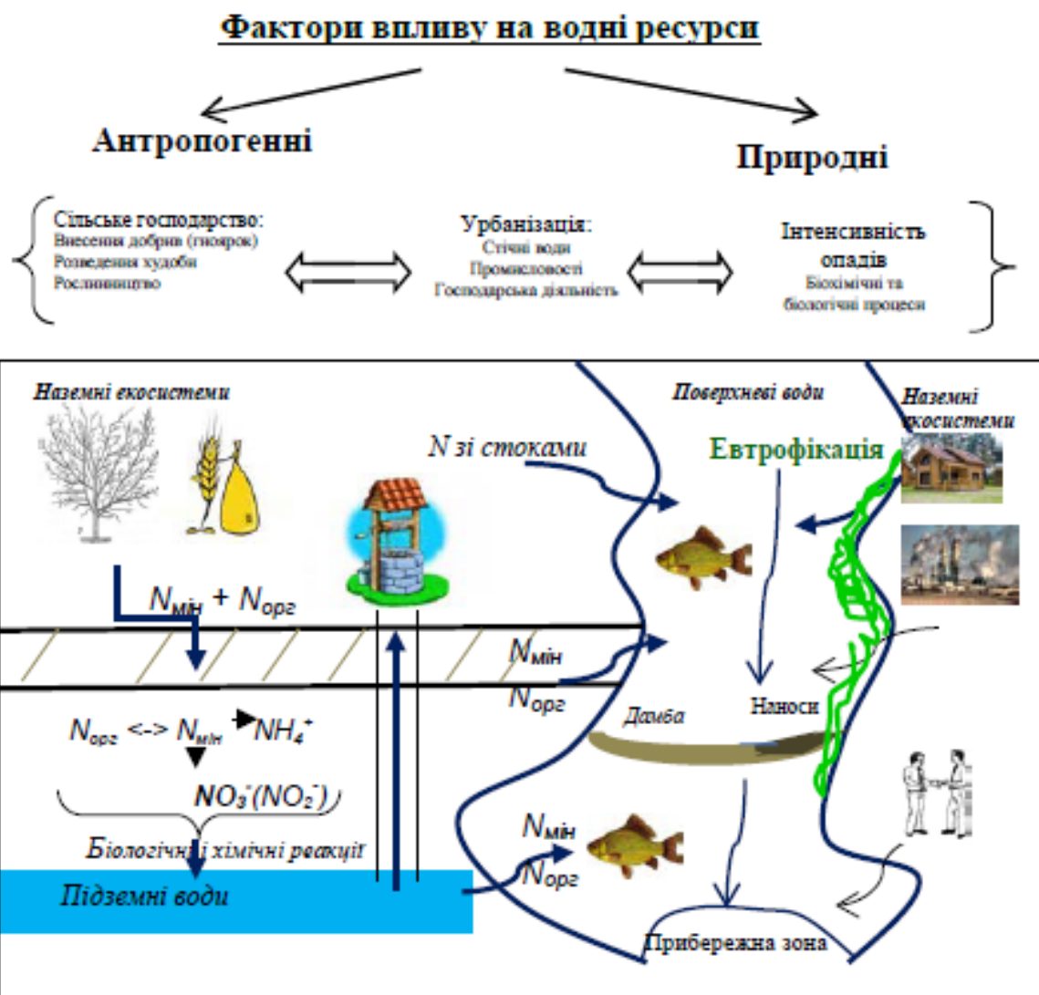
Рис. 4.5. Схематичне зображення основних факторів впливу на водні ресурси та шляхи надходження забруднювачів (на прикладі різних форм нітрогену, підвищений вміст якого спонукає евтрофікацію водойм). Розроблено М. П. Строкаль, В. П. Строкаль на основі літературних джерел (Копілевич В. А. та ін., 2004 р.; James J. Cabmerato, 2001; Bruce Seeing, 2000; Larry J. Puckett, 1994; WHO, 2011. Guidelines for Drinking-Water quality)
