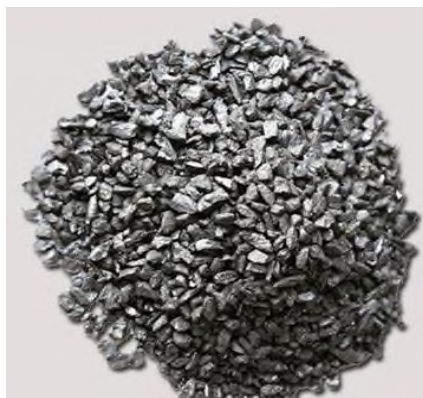
Рис. 11.1. «Чіпс»–модифікатор для отримання висоміцного чавуну
