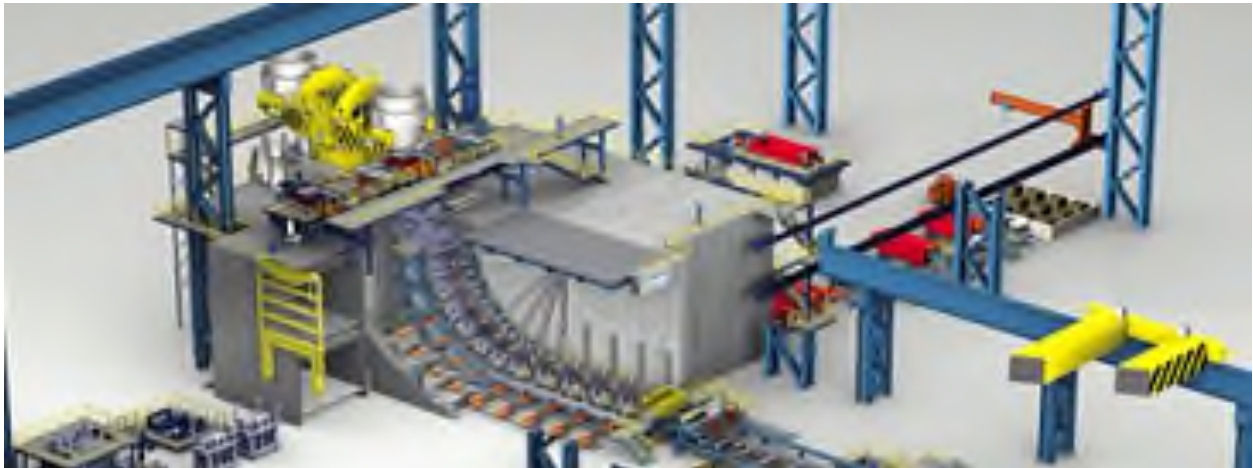
Рис. 6.3. Загальний вигляд сучасної одноструменевої слябової МБЛЗ
