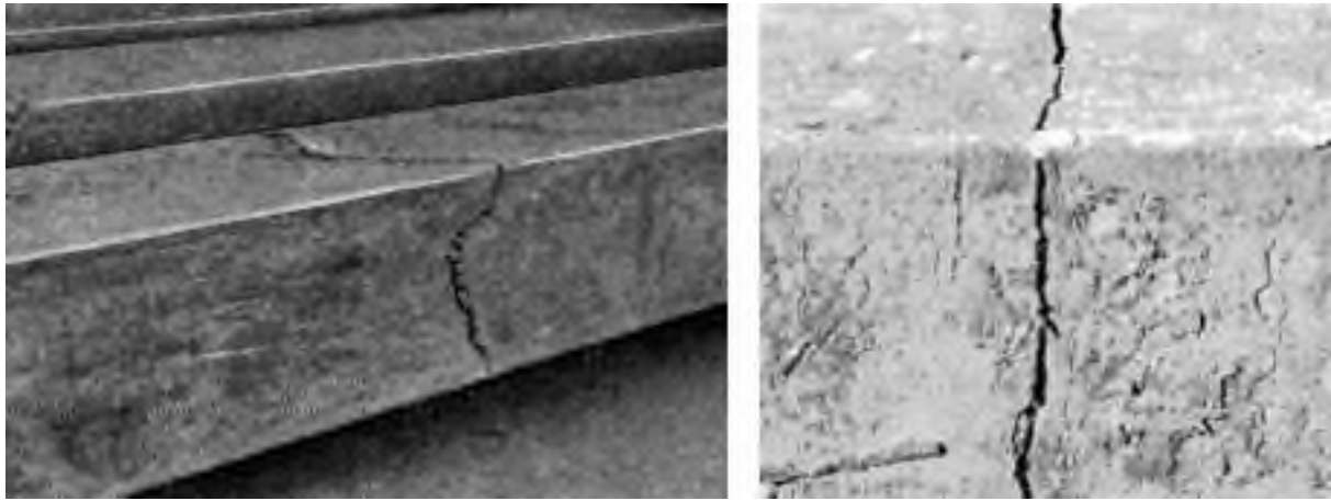
Рис. 8.4. Пояс на поверхні заготовки
