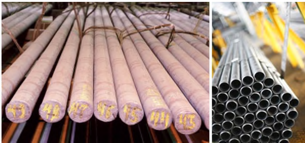
Рис. 6.1. Загальний вид круглої безперервнолитої заготовки (а) і безшовних труб, отриманих з них (б)
