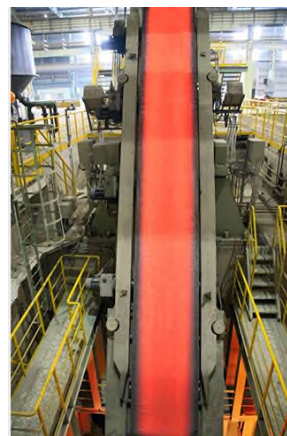
Рис. 4.3. Порізка слябу (а) та підъем слябу (б) на вертикальній МБЛЗ
