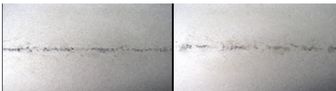
а – середня швидкість витягування заготовки 2,43 м/хв; б – середня швидкість витягування 3,28 м/хв
