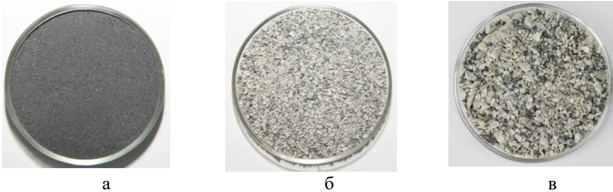
Рис. 18.3. Модифікатори типу L-CAST® 20 (а), L-CAST® 10 (б) та L-CAST® 5 (в)
