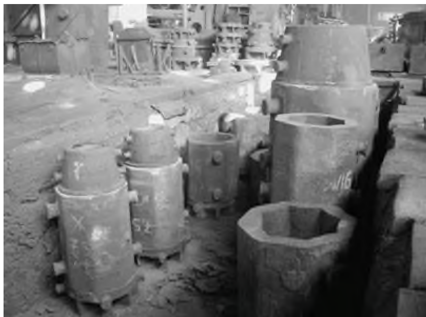
Рис. 2.6. Виливниці для розливки сталі зверху в сталерозливних канаві
