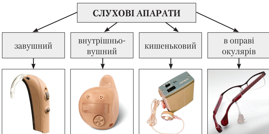
Схема 3. Типи слухових апаратів
