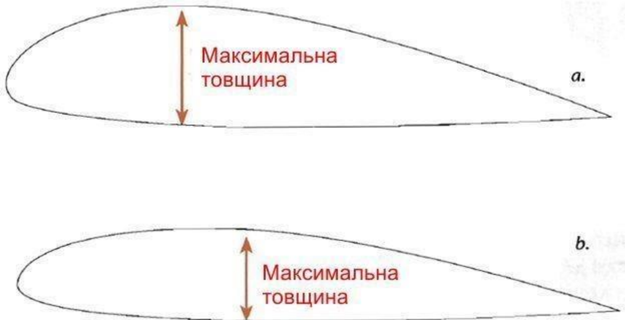
Рисунок 20. – а – профіль більшої товщини b – профіль меншої товщини .
