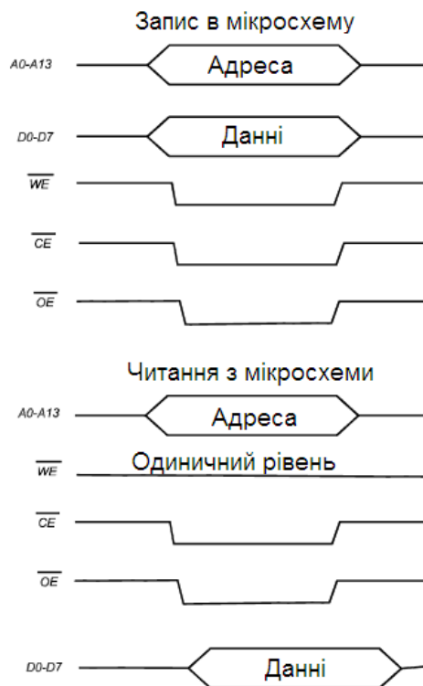
Рисунок 4.7 - Часові діаграмами запису та читання інформації
