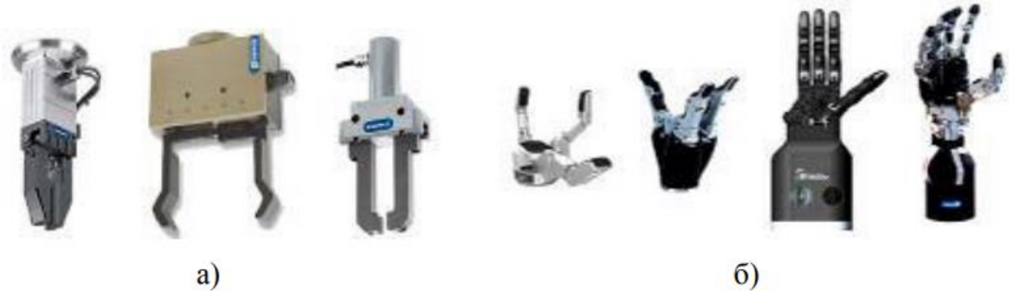
Рис. 9.2. Затискні (а) та антропоморфні (б) захоплюючі пристрої
