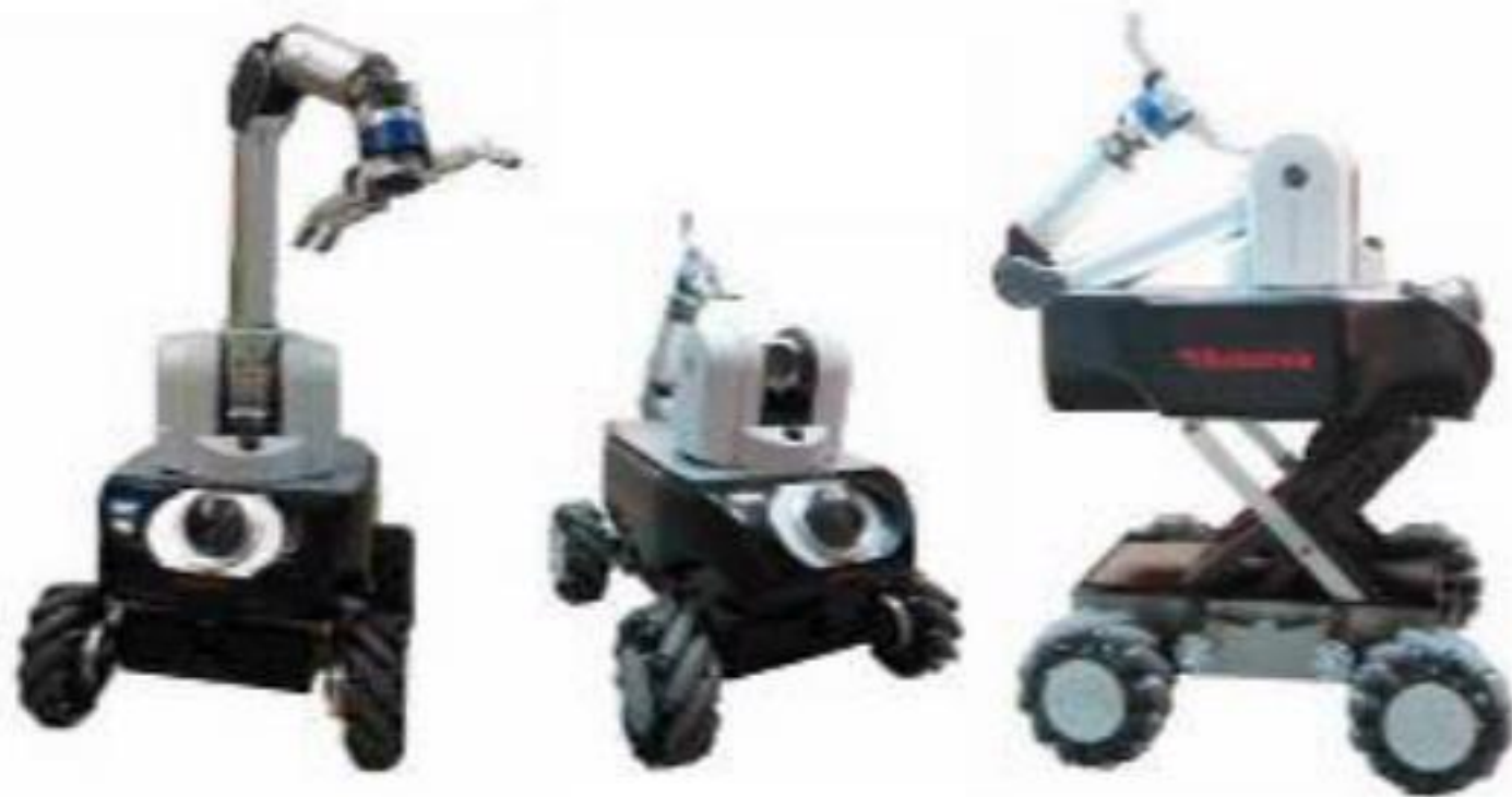
Рис. 9.7. Мобільний робот з багатоланковим маніпулятором та антропоморфним захоплюючим пристроєм
