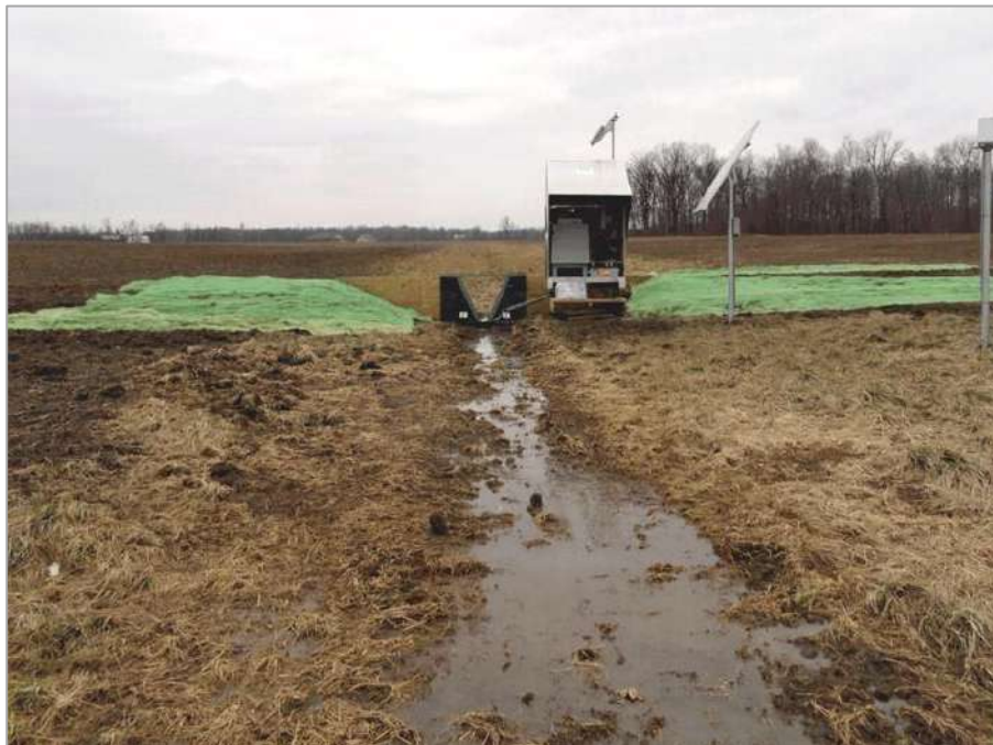
Рис. 8.2. Пост моніторингу стоку з сільгоспугідь, обладнаний гідрометричним лотком (штат Вісконсин, США)
