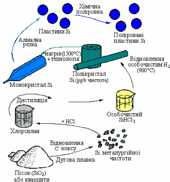
Рисунок 4.2 – Схема отримання напівпровідникового кремнію
