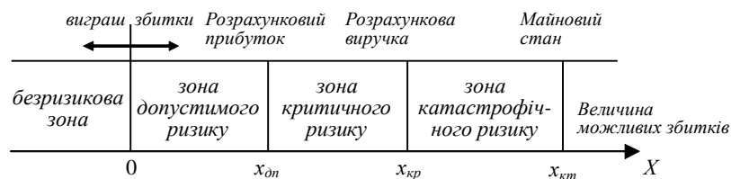
Рис. 2.1. Схема зон ризику і характерних точок
