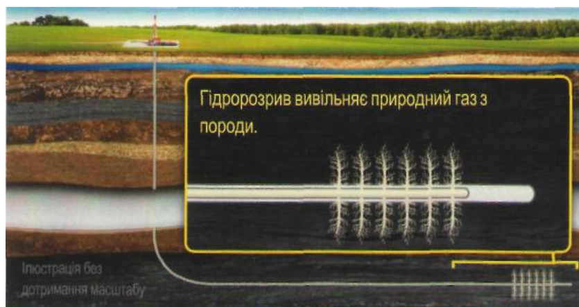
Рис.4.3. Схема створення гідророзриву у сланцевих пластах.
