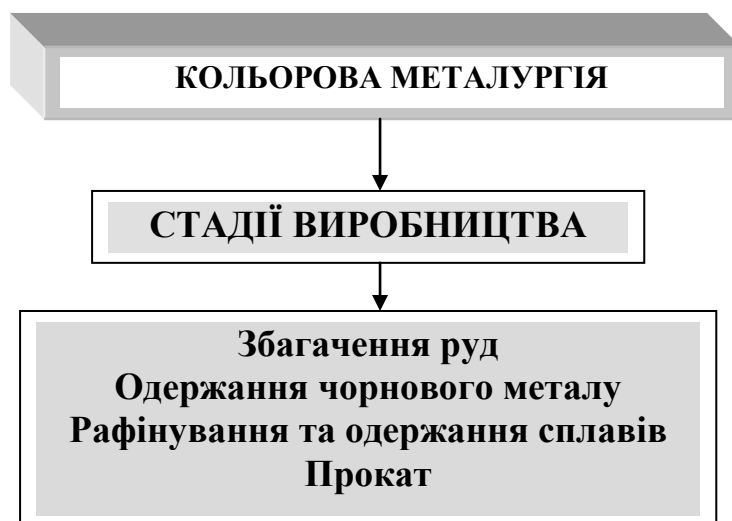
Рис. 3.9. Схема стадій виробництва кольорових металів та їх сплавів.
