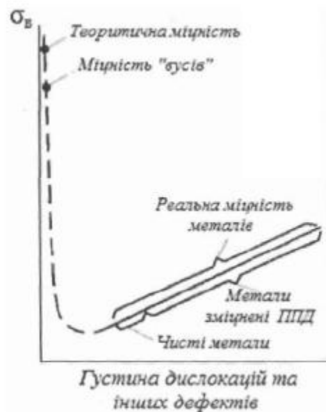
Рис. 2 – Вплив концентрації дефектів на міцність металу
