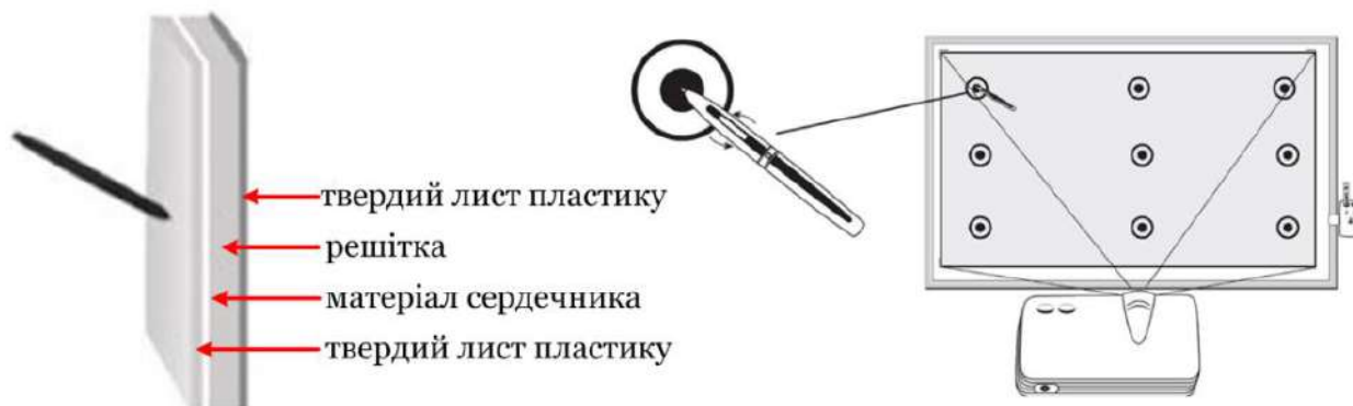
Рис. 2.8 – Принцип роботи дошки за електромагнітною технологією
