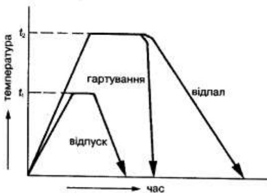
Рис. 4.1. Схематичне зображення різних операцій термічної обробки
