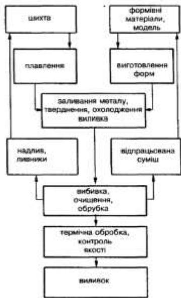
Рис. 6.11. Схема технологічного процесу виготовлення виливків
