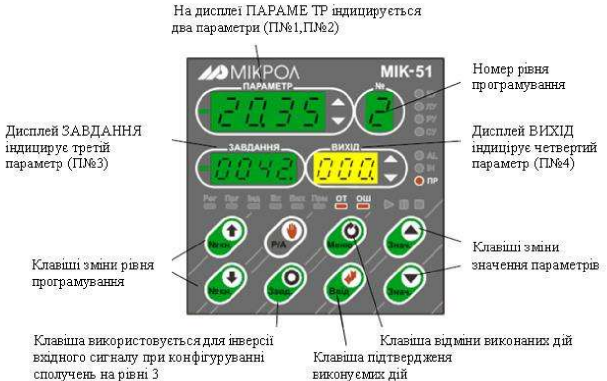
Рисунок 4.6 – Лицева панель контролера МІК-51 у режимі програмування
