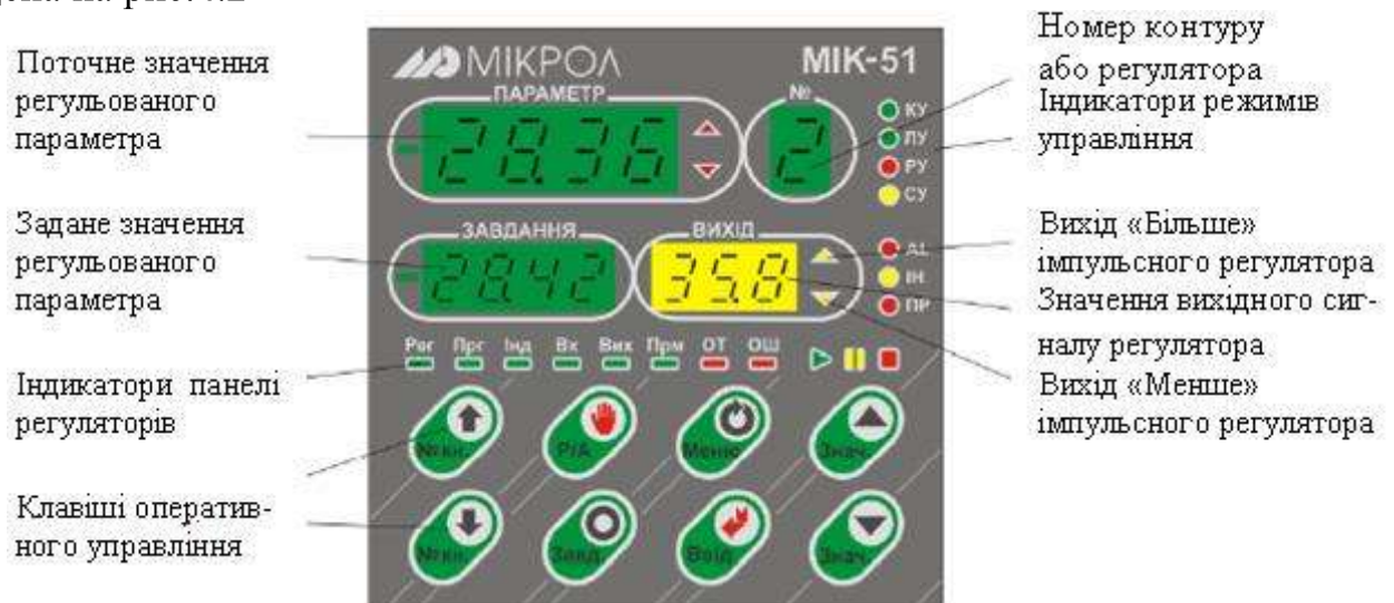
Рисунок 4.2 – Лицева панель МІК-51 в режимі оперативного управління
