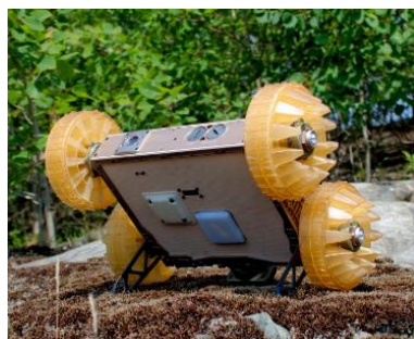
Рис. 1.89. Дослідний зразок міні-робота (а) та важільна система (б) для забезпечення стрибкоподібного руху
