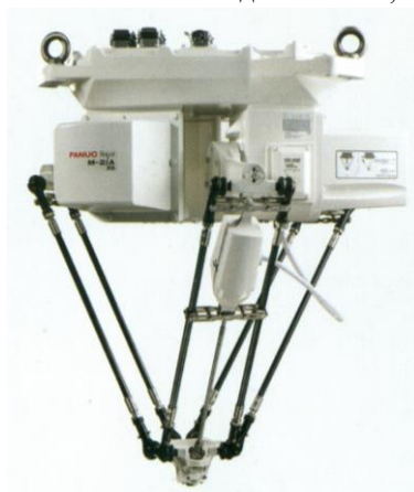
Рис. 2.66. Наземний роботизований комплекс М-2iA/3S (а) та модельний ряд роботів (б)
