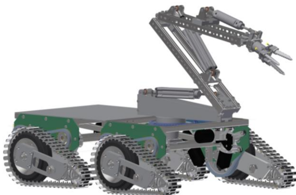
Рис. 12.12. Твердотільна модель наземного роботизованого комплексу у вигляді мобільної транспортної платформи оснащеної комплектним маніпулятором важільного типу
