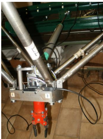
Рис. 14.16. Конструкція схвата, який встановлено на платформі наземного роботизованого комплексу
