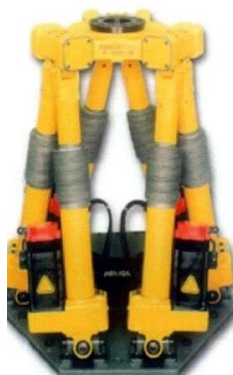
Рис. 2.7. Робот на основі механізму з паралельними кінематичними зв'язками реалізований по схемі механізму-гексапода
