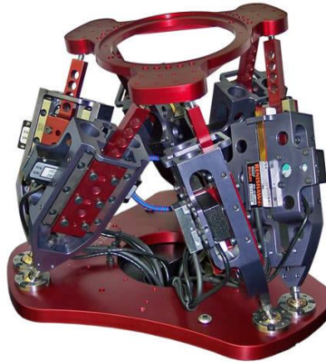
Рис. 2.58. Мікроманіпулятор побудований по схемі механізму-гексапода
