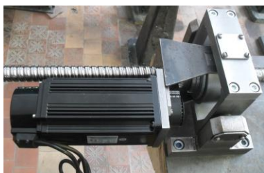
Рис. 14.13. Привід штанги змінної довжини з сервоприводом Maxsine EP2-TL12F: а - вигляд згори; б - вигляд збоку
