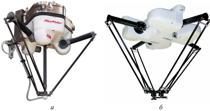
Рис. 2.63. Робот ABB Flexpicker (а) та робот Adept Quattro (б)
