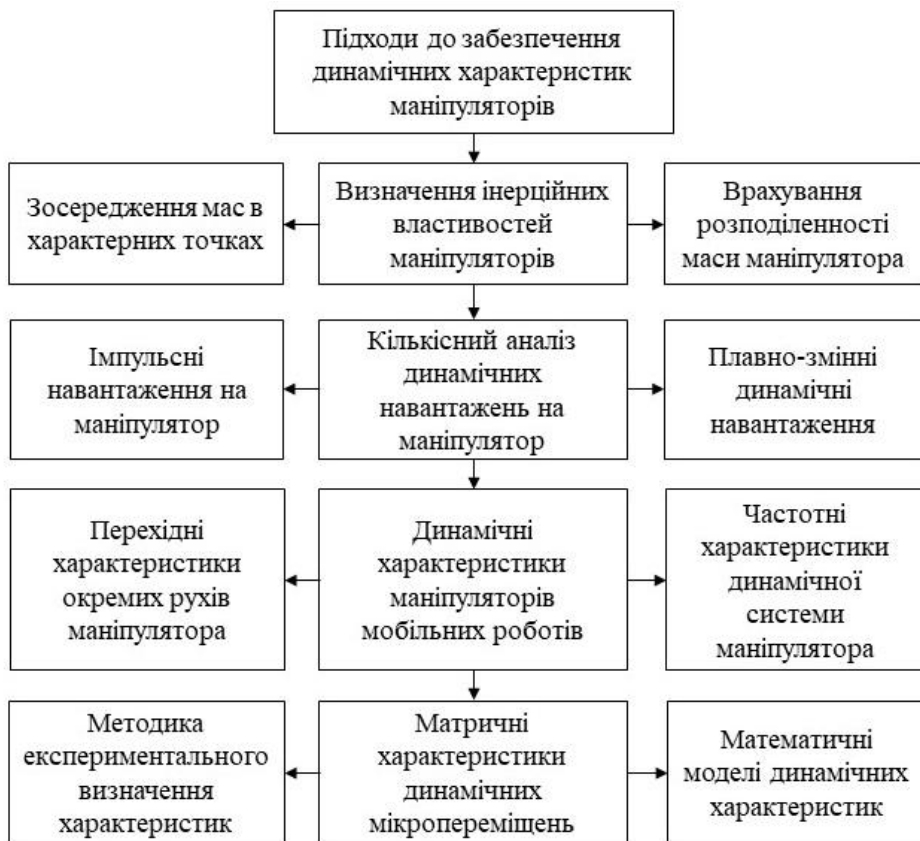
Рис. 10.15. Алгоритм формування підходів до забезпечення необхідних динамічних характеристик маніпуляторів мобільних роботів
