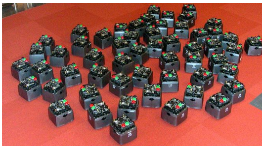
Рис. 1.66. Мініатюрні роботи, які утворюють організовану групу, здатну до об'єднання за певними законами
