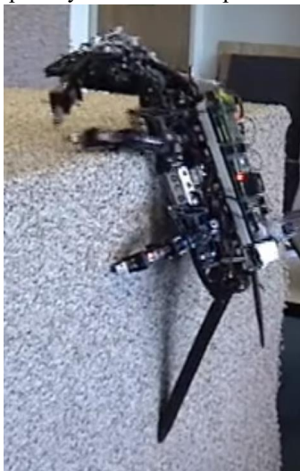
Рис. 1.72. Переміщення крокуючого робота по вертикальній стінці
