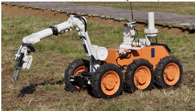
Рис.1.28. Роботизований комплекс для роботи в умовах підвищеної радіації
