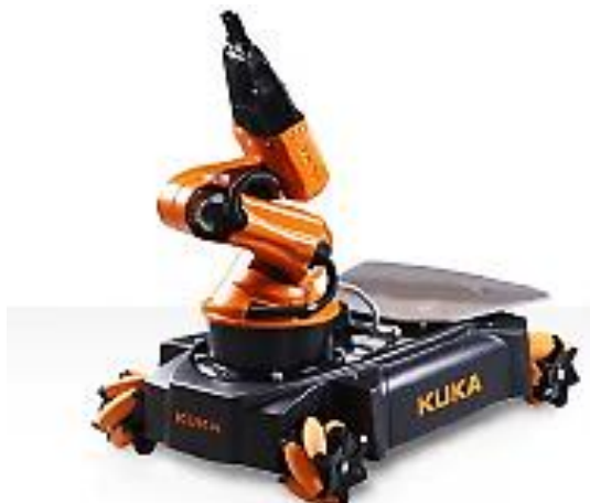
Рис. 1.57. Промисловий робот KUKA встановлений на рухомій платформі
