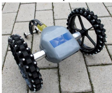
Рис. 1.76. Легкий робот з магнітними колесами (а) та переміщення робота по вертикальній стінці (б)
