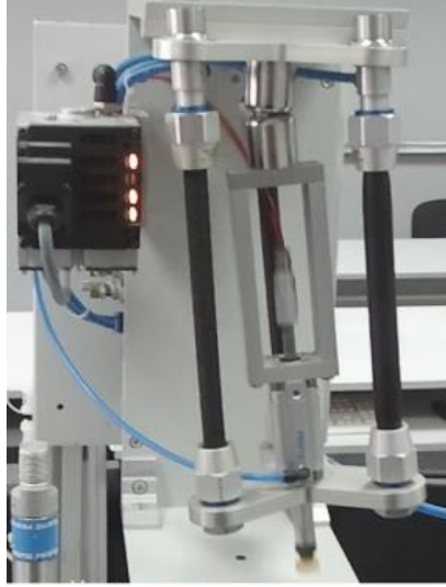
Рис. 2.12. Наземний роботизований комплекс фірми FESTO з приводами у вигляді шлангових пневмодвигунів
