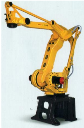
Рис. 2.32. Загальний вигляд типового представника серії M-410 наземного роботизованого комплексу M-410iC/185 (а) та моделі роботів (б)
