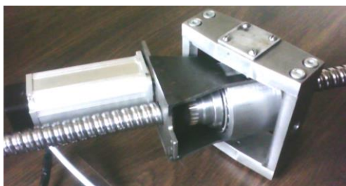
Рис. 14.13. Привід штанги змінної довжини з сервоприводом Maxsine EP2-TL12F: а - вигляд згори; б - вигляд збоку
