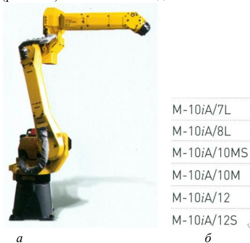
Рис. 2.30. Типовий представник серії М-10 робот М-10iA/12 (а) та модельний ряд роботів даної серії (б)
