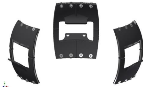
Рис. 13.7. Розташування пар накладок по периметру тороподібної рами
