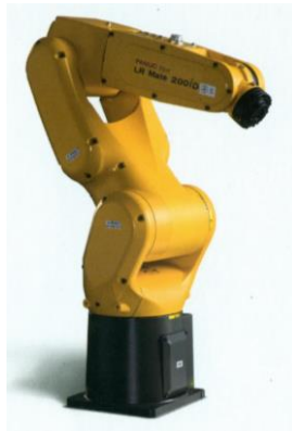
Рис. 2.26. Типові представники серії малих роботів LR Mate: а – загальний вигляд; б – модельний ряд
