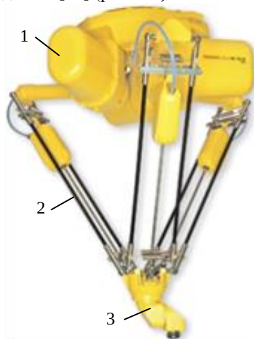
Рис. 2.8. Наземний роботизований комплекс з паралельними кінематичними зв'язками побудований по схемі дельта
