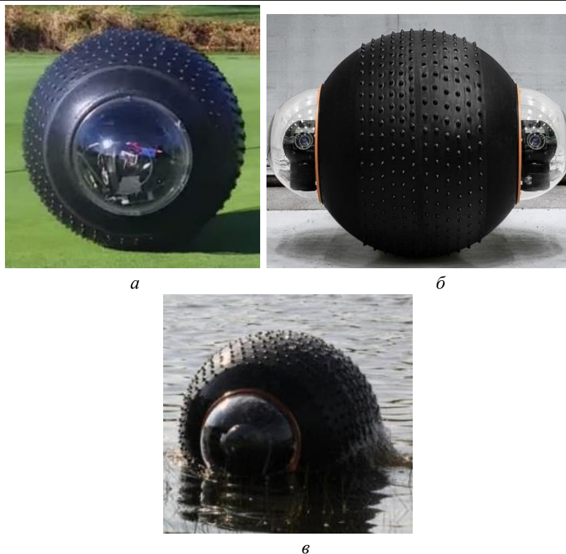
Рис. 1.58. Сферичний мобільний робот спеціального призначення: а – вид збоку; б – вид спереду; в – рух по воді
