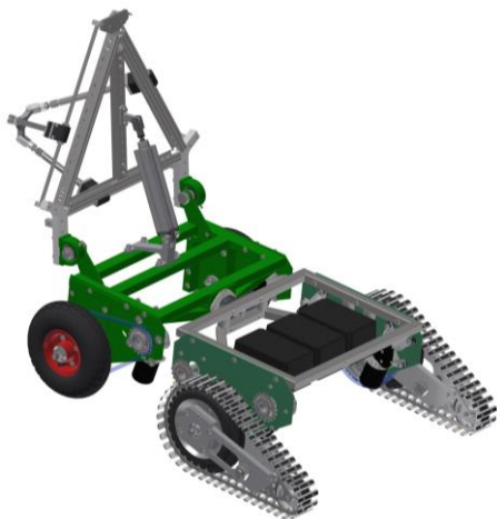
Рис. 12.14. Твердотільна модель наземного роботизованого комплексу шасі якого сформовано із модулів колісного та гусеничного типу, а маніпулятор виконано на основі механізму із паралельними кінематичними структурами
