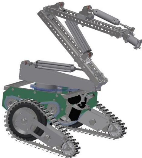
Рис. 12.10. Твердодільна модель запропонованого автономного модуля шасі гусеничного типу із встановленим на ньому маніпулятором
