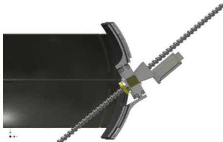
Рис.13.8. Схема закріплення шарнірів на рам маніпулятора
