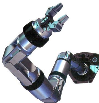
Рис. 2.9. Наземний роботизований комплекс у вигляді ланцюгової конструкції складеної із окремих однотипних елементів з поворотними приводами
