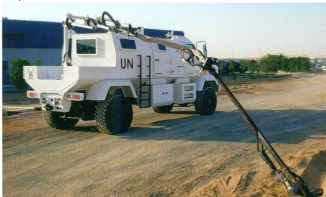
Рис. 1.26. Великогабовий наземний роботизований комплекс спеціального призначення на базі КРАЗ
