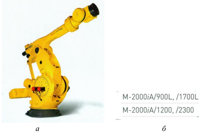
Рис. 2.35. Типовий робот серії M-2000 вантажопідйомністю 1700 кгс моделі M-2000iA/1700L (а) та модельний ряд серії (б)
