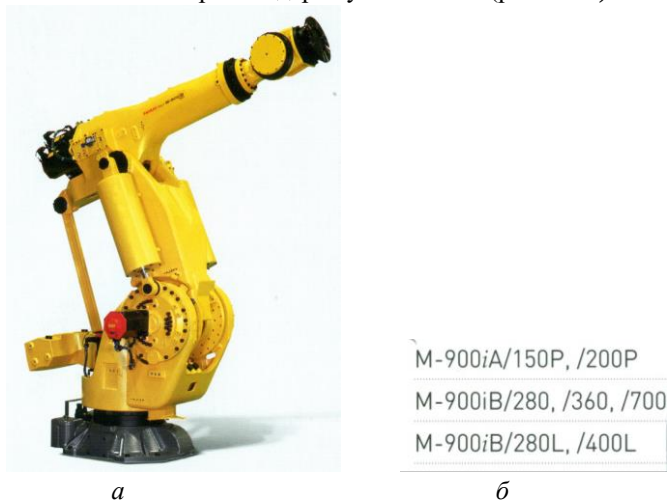
Рис. 2.34. Представник серії M-900 наземний роботизований комплекс M-900iB/700 (а) та модельний ряд роботів (б)
