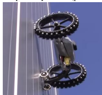
Рис. 1.76. Легкий робот з магнітними колесами (а) та переміщення робота по вертикальній стінці (б)
