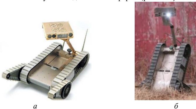
Рис. 1.45. Забезпечення поворотного руху чутливого блока (а) та додаткове підняття блока за допомогою фліперів платформи робота (б)
