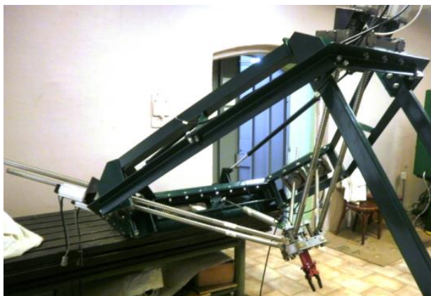
Рис. 14.17. Наземний роботизований комплекс в процесі експериментальних досліджень із страховочними стійками встановленими на рамі
