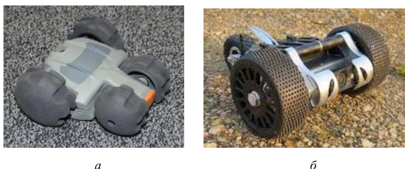
Рис. 1.85. Полегшені варіанти чотириколісного робота (а) та триколісного робота (б)
