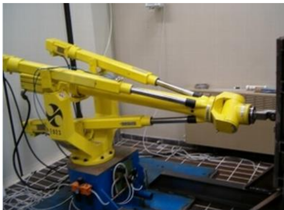
Рис. 2.44. Загальний вигляд маніпулятора побудованого по схемі механізма-трипода
