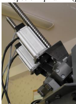
Рис. 14.15. Розташування подвійної шарнірної опори штанг змінної довжини на рамі наземного роботизованого комплексу
