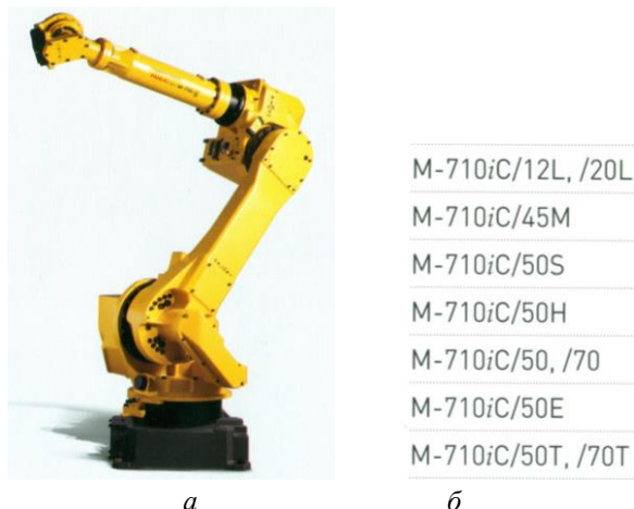
Рис. 2.33. Загальний вигляд робота M-710iC/50 (а) та модельний ряд роботів серії M-710 (б)
