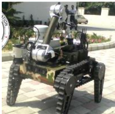
Рис. 1.29. Конструктивне виконання наземного роботизованого комплексу для роботи з токсичними, радіоактивними та біологічно небезпечними речовинами
