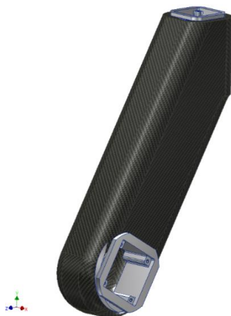
Рис. 13.15. - Корпусна деталь верхнього важеля крокуючого робота
