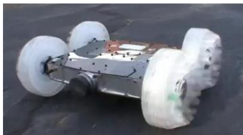
Рис. 1.89. Дослідний зразок міні-робота (а) та важільна система (б) для забезпечення стрибкоподібного руху
