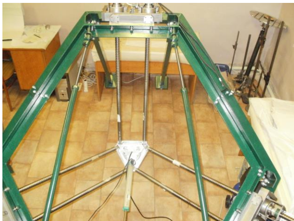
Рис. 14.12. Дослідний зразок рамної конструкції наземного роботизованого комплексу із штангами змінної довжини та рухомою платформою при вигляді згори
