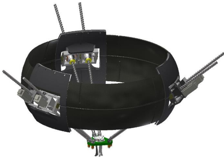
Рис. 13.6. Раціональний варіант виконання несучої рами маніпулятора виконаної із композитних матеріалів
