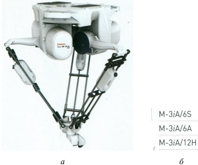
Рис. 2.67. Робот M-3iA/6A (а) та модельний ряд роботів серії M-3 (б)
