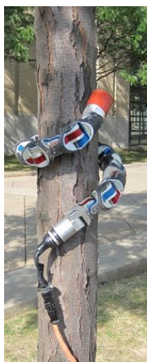
Рис. 1.60.. Переміщення робота у вигляді лінійної структури по зовнішній циліндричній поверхні: а – циліндрична поверхня великого діаметра; б – циліндрична поверхня малого діаметра
