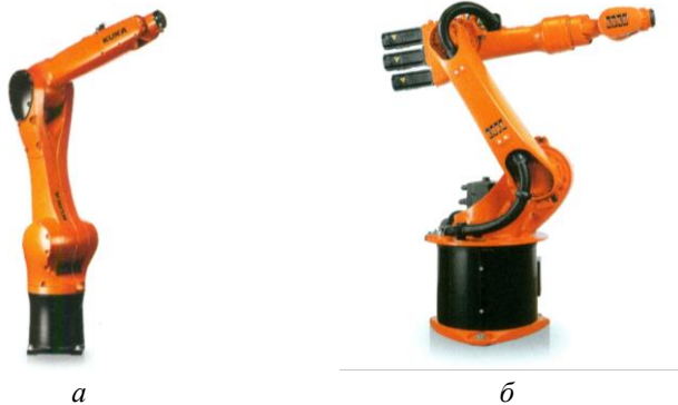
Рис. 2.13. Роботи фірми KUKA віднесені до легкого і надлегкого класів: а – робот серії KR 16-2; б – робот серії KR AGILUS
