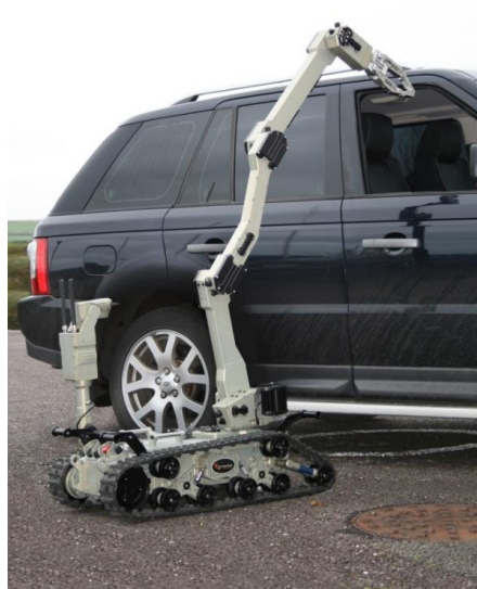
Рис. 1.50 – Наземний роботизований комплекс AVENGER ROV: загальний вид (а) та проникнення маніпулятором в салон замінованої машини (б)
