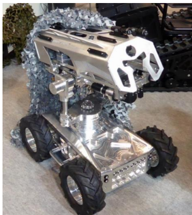
Рис. 1.48. Наземний роботизований SNIBOT, який має розвинену маніпуляційну систему
