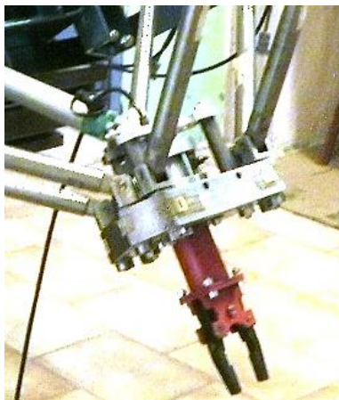
Рис. 14.19. Конструкція захватного пристрою з важелями, які переміщуються і повертаються пневмоциліндрами
