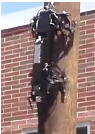
Рис. 1.74. Крокуючий робот Rise V3, який перміщується по вертикальному стовпі
