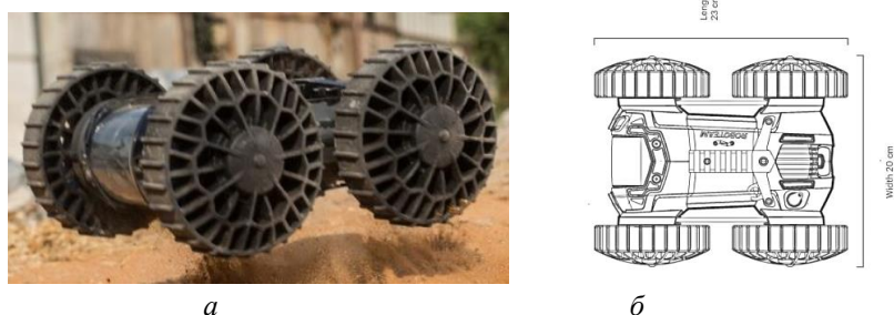
Рис. 1.84. Загальний вигляд міні-робота IRIS (а) та його схематичне зображення (б)
