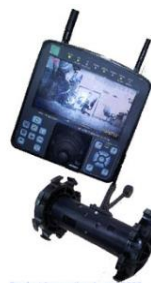
Рис. 1.87. Міні-робот MOLE (а) та пристрій його керування (б)
