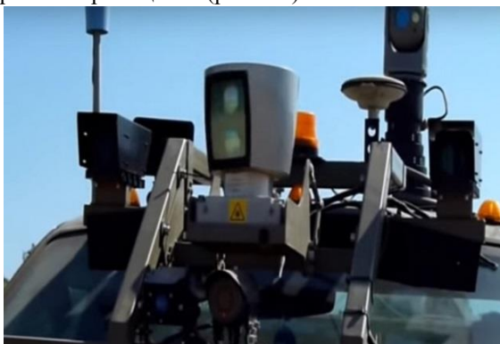
Рис. 1.6. Роботизований комплекс AVANTGUARD MKIII оснащений стереоскопічною оптичною системою
