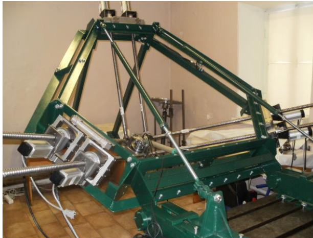
Рис. 14.11. Дослідний зразок рамної конструкції наземного роботизованого комплексу із штангами змінної довжини та рухомою платформою при вигляді збоку
