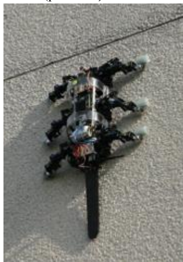
Рис. 1.72. Переміщення крокуючого робота по вертикальній стінці
