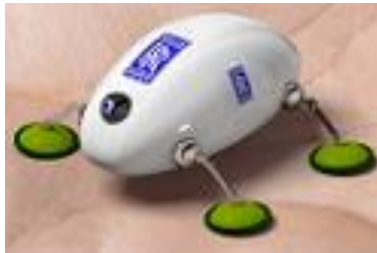
Рис. 1.71. Мініатюрний робот призначений для діагностики газотурбінних двигунів
