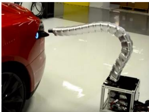
Рис. 2.10. Робот консольного типу у вигляді ланцюга послідовно з'єднаних елементів
