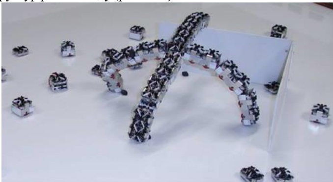
Рис. 1.67. Приклад формування ланцюгової структури із мініатюрних роботів
