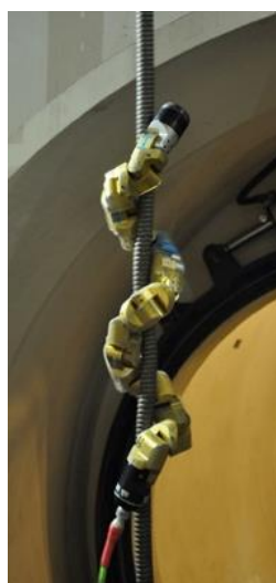
Рис. 1.60.. Переміщення робота у вигляді лінійної структури по зовнішній циліндричній поверхні: а – циліндрична поверхня великого діаметра; б – циліндрична поверхня малого діаметра
