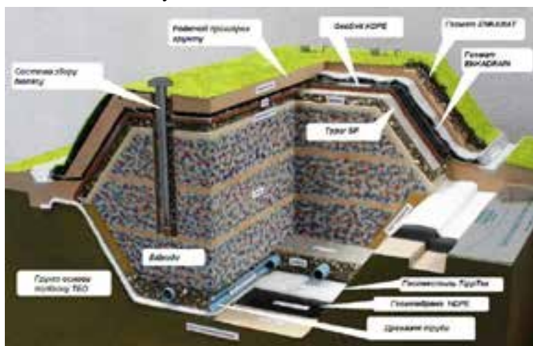
Рис. 4. Схема конструкції полігона відходів
