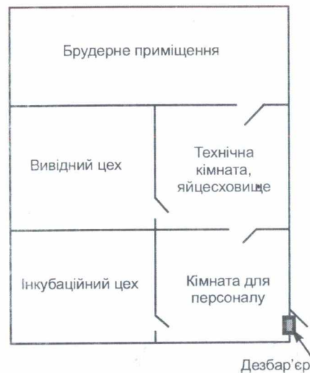
Рис. 8.1. Орієнтовна схема інкубаторію з найважливішими приміщеннями, необхідними для організації його роботи
