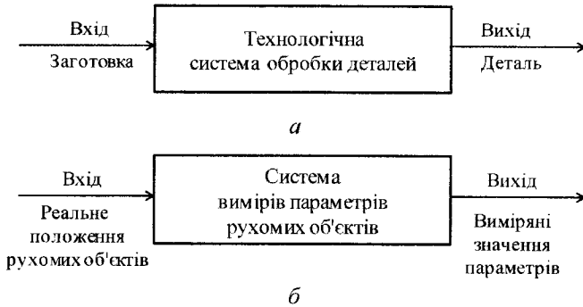
Рис. 2.5. Приклади технічних систем: а – оброблювальна система; б – вимірювальна система
