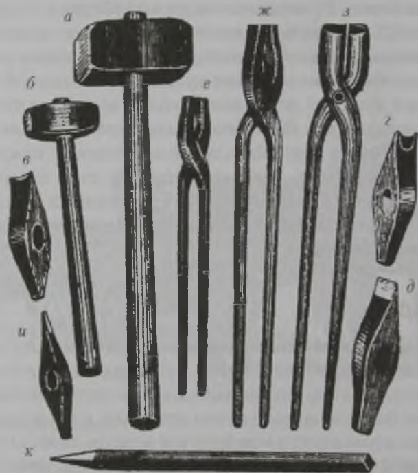
Рис. 55. Инструменты для изготовления подков: а — большой кузнечный молот массой 4 кг; б — ручной молоток; в — стальной дорожник для пробивания гвоздевой дорожки; г — стальное зубило для обрубания концов подков; д — стальное плоское зубило для обрубания полос железа; е — клещи ручные железные для держания изготавливаемой подковы; ж — клещи горновые; з — клещи проварочные для удержания свариваемых кусков железа; и — стальной пробойник для пробивания гвоздевых отверстий; к — стальная шпилька для прочистки отверстий в подкове
