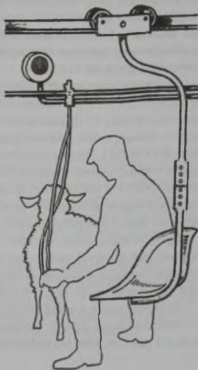
Рис. 48. Схема расположения дояра и овцы на установке ДЗО-8
