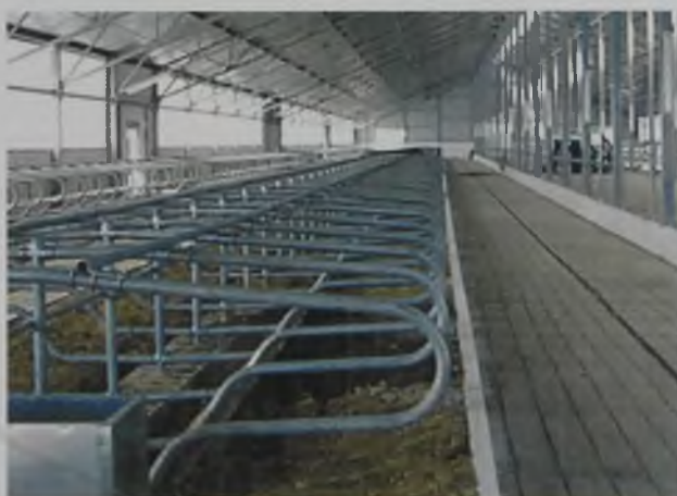
Рис. 37. Коровник для беспривязного содержания с боксами
