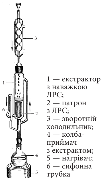
Рис. 3.1. Апарат Сокслета
