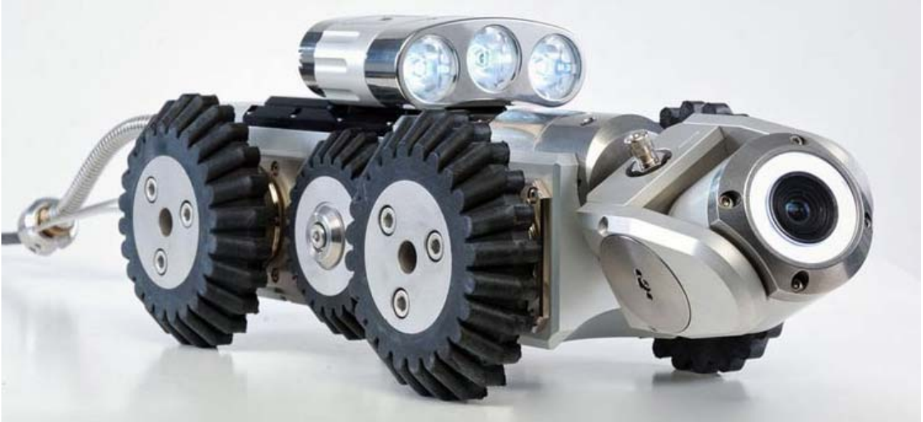
Рисунок 4.6 – Телевізійна камера для діагностики каналізаційних мереж
