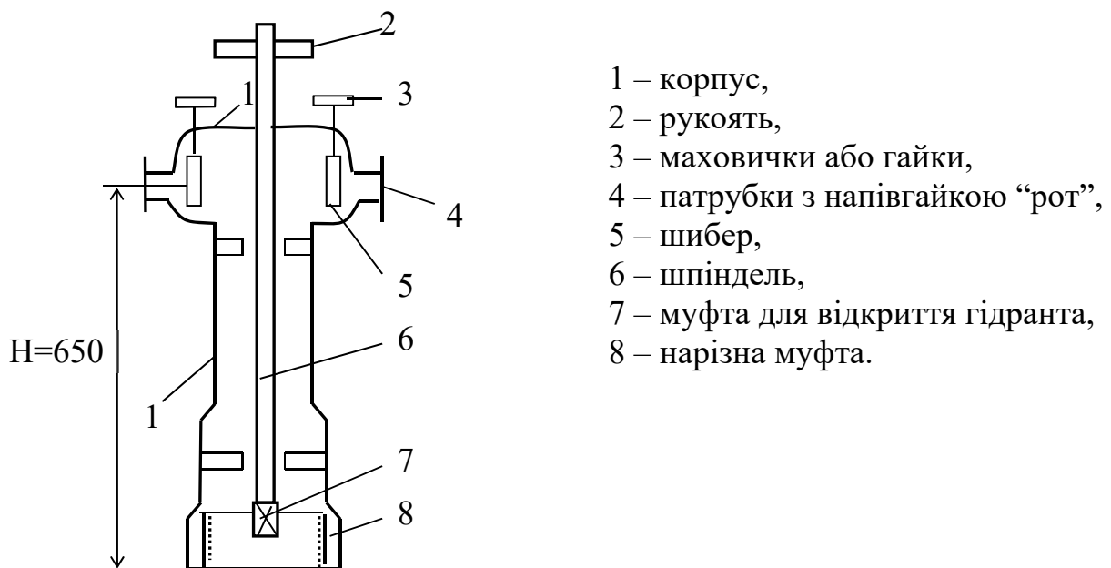
Рисунок 4.5 – Колонка (стендер) для пожежного гідранта
