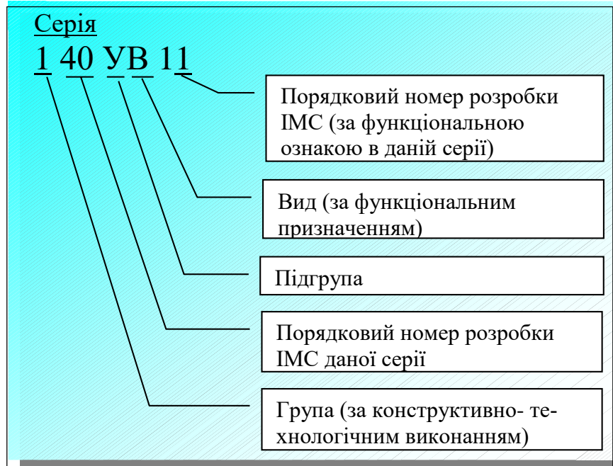
Рисунок 1.1 - Приклад умовних позначень напівпровідникової інтегральної мікросхеми
