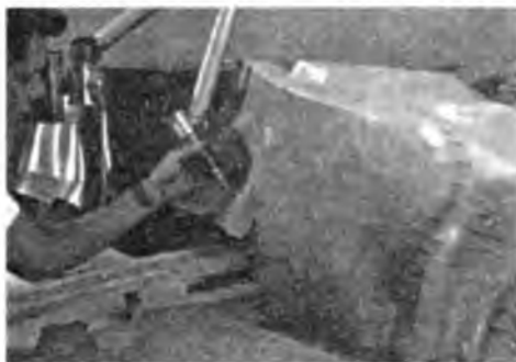
Рис. 5.4.7. Дослідний музичний центр Experience Music Project (EMP), м. Сіетл, США, арх. Ф. О. Гері, 1995–2000 рр. Обробка моделі дигитайзером
