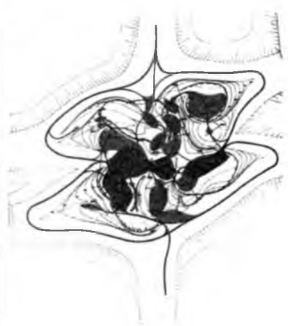
Рис. 5.4.10. Павільйон Son-O-House біля м. Роттердам, Нідерланди, арх. Група NOX, 2000–2003 рр. Комп'ютерна модель павільйону. Схема фіксації датчиками перемішень людей для генерації музики різних регістрів
