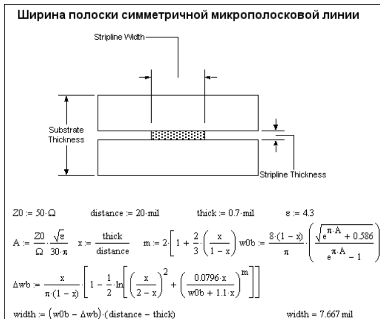
Рис. 12.58. Расчет ширины проводящей полоски микрополосковой линии
