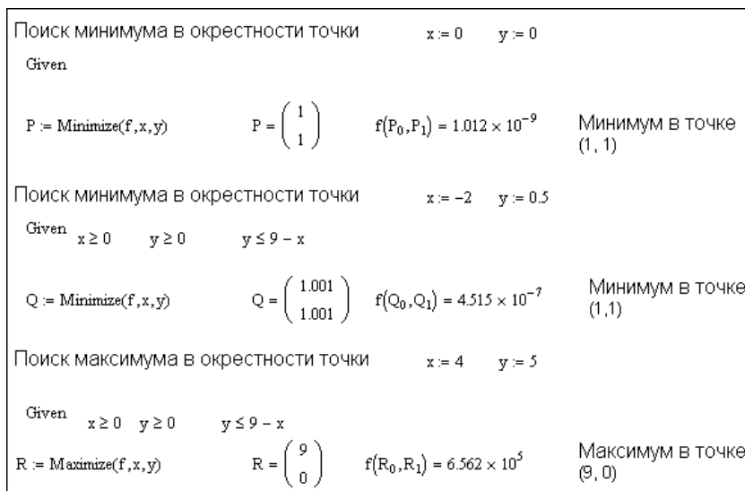
Рис. 7.12. Окончание документа с решением задачи поиска минимума и максимума функции Розенброка с учетом ограничений
