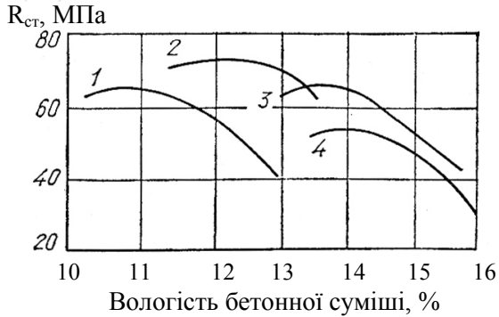
Рис. 9.5. Залежність міцності при стиску шлаколужного бетону від вологості суміші і масової частки глинистих часток у заповнювачі : 1 – 1,2%; 2 – 5,2%; 3 – 6,4%; 4 – 8,8%.
