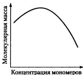
Рис. 4.21. Общий вид зависимости молекулярной массы полимера от концентрации мономеров при поликонденсации в растворе
