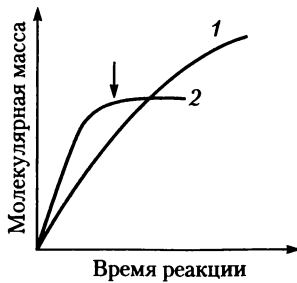
Рис. 4.25. Нарастание молекулярной массы полимера в процессе поликонденсации в гомогенном растворе (1) и с выпадением полимера из раствора (2) (стрелкой отмечено время выделения полимера из раствора)
