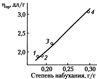
Рис. 4.26. Изменение приведенной вязкости полиарилата на основе дихлорангидрида терефталевой кислоты и фенолфталеина в зависимости от степени набухания полимера в растворителе:
