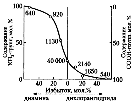
Рис. 4.10. Зависимость содержания концевых групп от исходного соотношения мономеров при синтезе ароматических полиамидов в растворе в присутствии акцептора HCl (цифры у точек — молекулярная масса полимера):
