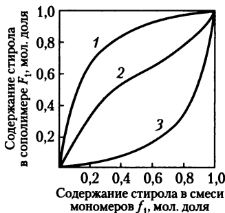
Рис. 3.26. Зависимость состава сополимеров стирола ( M_1 ) с метилметакрилатом ( M_2 ) при катионной (1), радикальной (2) и анионной (3) сополимеризации под действием \text{SnCl}_4 , пероксида бензоила и \text{NaNH}_2 соответственно
