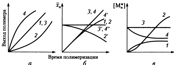
Рис. 3.15. Изменение в процессе ионной полимеризации выхода полимера (а), его среднечисловой степени полимеризации (б) и концентрации активных центров (в):
