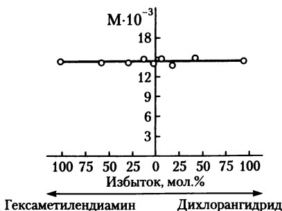
Рис. 4.32. Влияние соотношения исходных мономеров (варьирование объемов фаз) на молекулярную массу полигексаметиленадипамида, синтезируемого межфазной поликонденсацией на границе раздела фаз «жидкость — жидкость»
