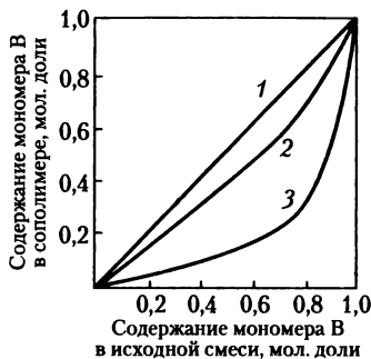
Рис. 4.12. Зависимость содержания в сополимере звеньев сомономера В от его содержания в исходной смеси при сополиконденсации дихлорангидрида изофталевой кислоты со смесью двух мономеров А и В:
