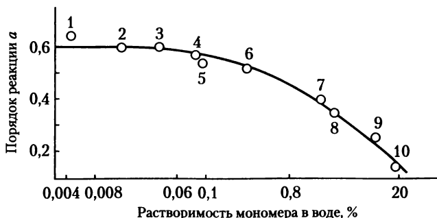
Рис. 3.14. Зависимость порядка реакции по эмульгатору \alpha от растворимости мономеров в воде:
