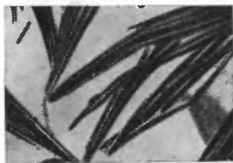
Рис. 127. Отдельные фибриллярные образования в полиамиде
