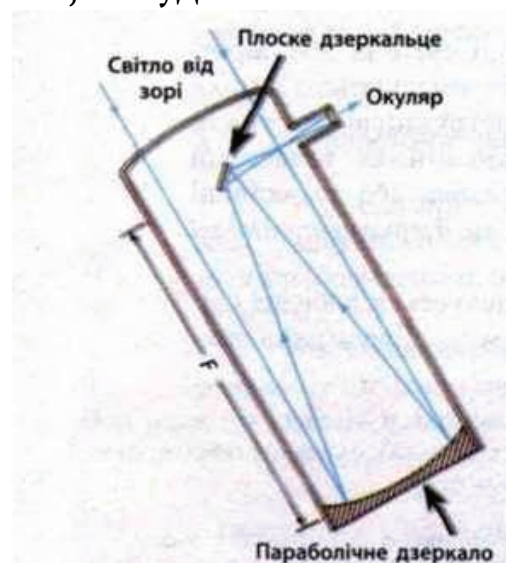
Рис. 6. Схема дзеркального телескопа
