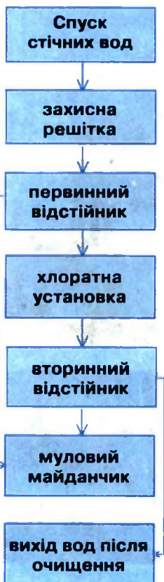
Схема очищення стічних вод
