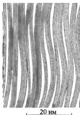
Рисунок 1.1 - Схематичне зображення стрічкової структури вуглецевого волокна
