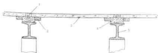
Рис. 9. Планшет сцены: 1 — междущитовая прокладка; 2 — шпонка; 3 — щитнастила; 4 — подщитовая
