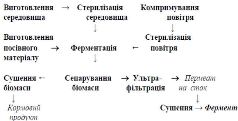
Рисунок 5.7 – Блок-схема виробництва технічних неклітинних ферментів
