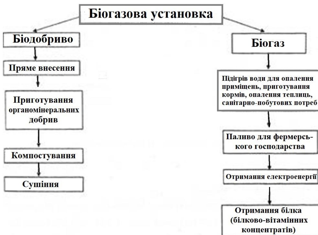
Рисунок 3.3 – Використання продуктів переробки відходів в біогазовій установці
