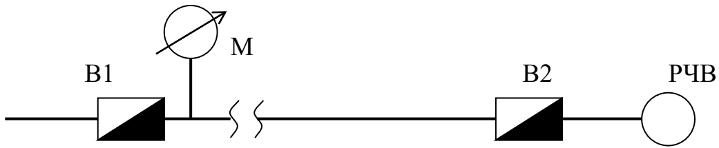
М–манометр, В1,В2–водоміри (лічильники), РЧВ–резервуар чистої води Рисунок 8.2.3 – Схема випробування за допомогою водомірів (1 варіант)
