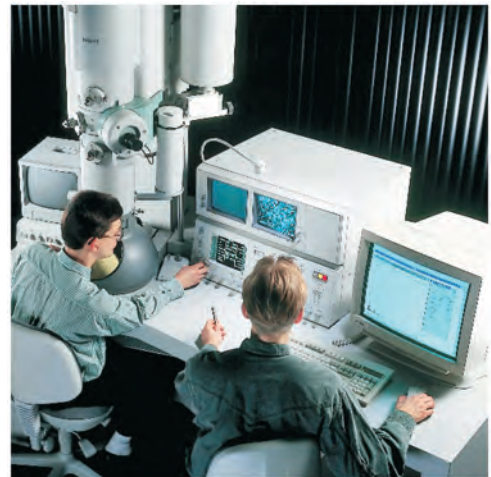
Рис. 9.42. Принципиальное строение светового микроскопа и трансмиссионного электронного микроскопа. На данном рисунке отмечено сходство внутреннего устройства микроскопов. Стеклянным линзам светового микроскопа в электронном микроскопе соответствуют магнитные катушки. В электронном микроскопе необходимо, чтобы образец находился в вакууме. На фотографии показан рабочий трансмиссионный микроскоп. (Фотография приведена с юбезного разрешения FEI Company Ltd.)
