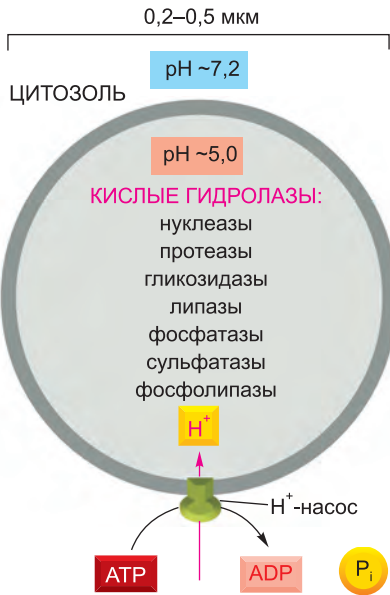
Рис. 13.36. Лизосомы. Кислые гидролазы – это гидролитические ферменты, активные в кислой среде. АТРаза V-типа в мембране лизосомы накапливает внутрь H^+ , поддерживая кислый рН люмена.
