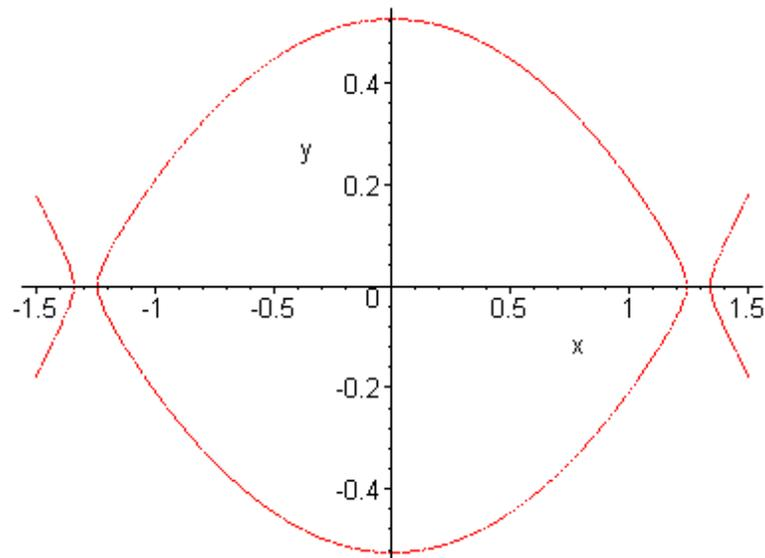
Рис.5.2 Между замкнутой и разомкнутыми линиями уровня функции Ляпунова (на оси абсцисс) находятся седловые особые точки, ограничивающие область притяжения нулевого решения.
