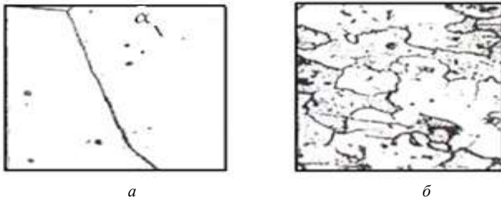
Рис. 16.3 Структура дюралюмінію: а - після гартування; б – після старіння
