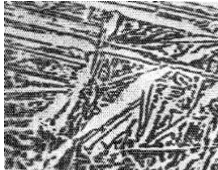
Рис. 17.8. Мікроструктура бронзи БрА10: a – після деформації; б – після гартування
