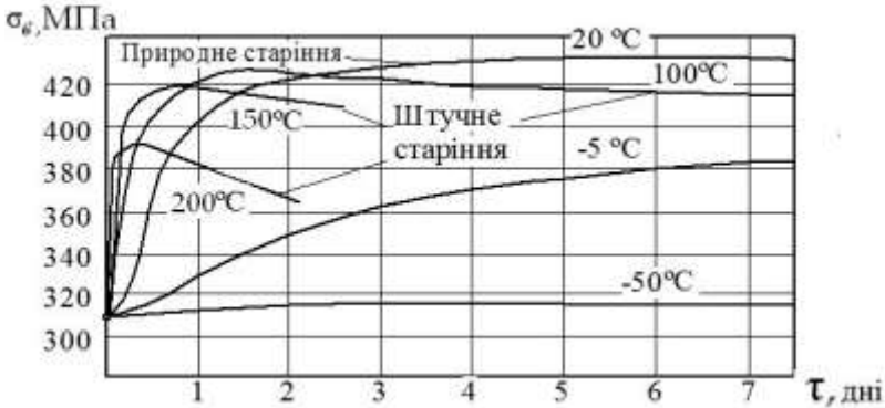
Рис. 16.2. Вплив температури і часу старіння на міцність алюмінієвих сплавів
