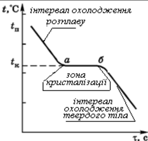
Рис. 4.4. Крива охолодження чистого металу
