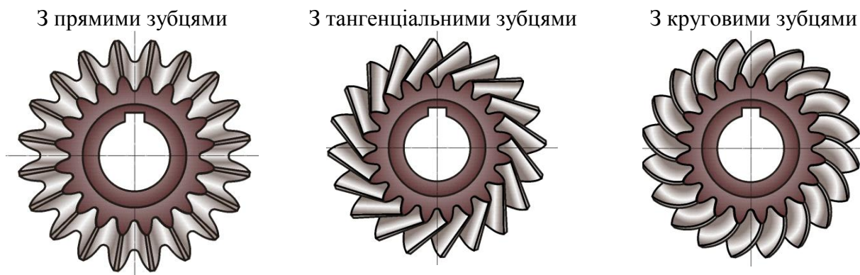
Рисунок 4.12 - Види конічних передач залежно від форми лінії зуба
