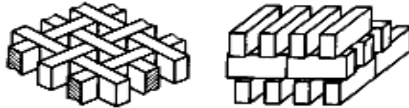
а) насадка Каупера б) насадка Сименса
