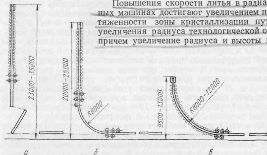
Рис. IV.1. Схемы сопоставления высот машин непрерывного литья заготовок различных типов:
