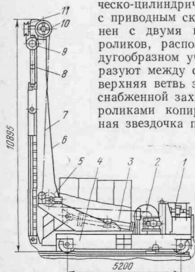
Рис. IV.28. Машина для ввода затравки в кристаллизатор сверху конструкции УЗТМ
