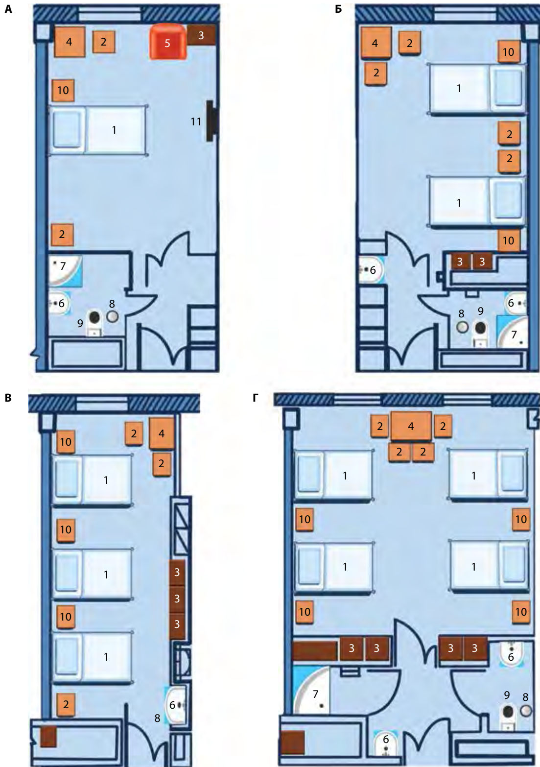
Рис. 17.5. Варіанти планування та обладнання лікарняних палат (А – одноліжкова, Б – дволіжкова, В – тріліжкова, Г – чотириліжкова). 1 – ліжко; 2 – стілець; 3 – шафа; 4 – стіл; 5 – крісло; 6 – умивальник; 7 – душ; 8 – відро; 9 – унітаз; 10 – приліжкова тумбочка; 11 – телевізор
