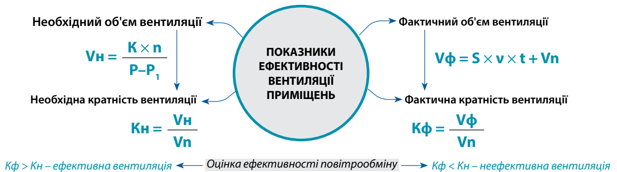
Рис. 13.4. Оцінка ефективності вентиляції в приміщенні
