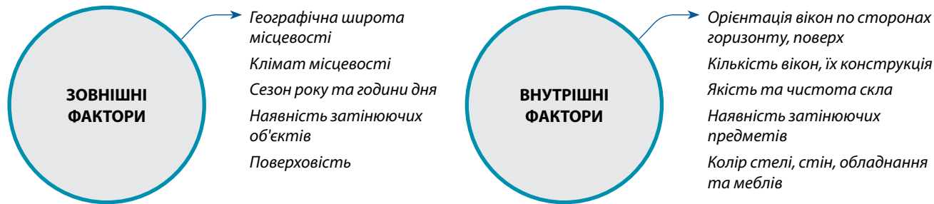
Рис. 11.3. Вплив зовнішніх і внутрішніх факторів на рівень природного освітлення в приміщенні
