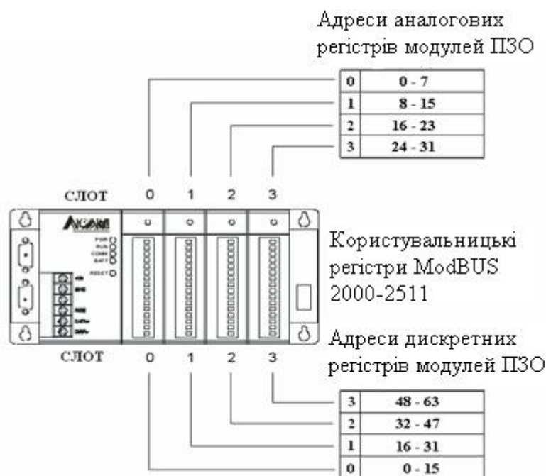
Рисунок 5.5 – Адресація регістрів модулів ПЗО серії «ADAM 5000»
