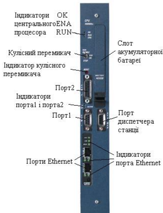
Рисунок 11.4 – Модуль центрального процесора PACSystems RX7i
