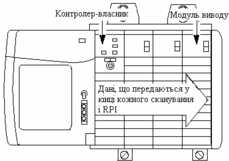
Рисунок 10.7 – Модуль виводу у локальному шасі
