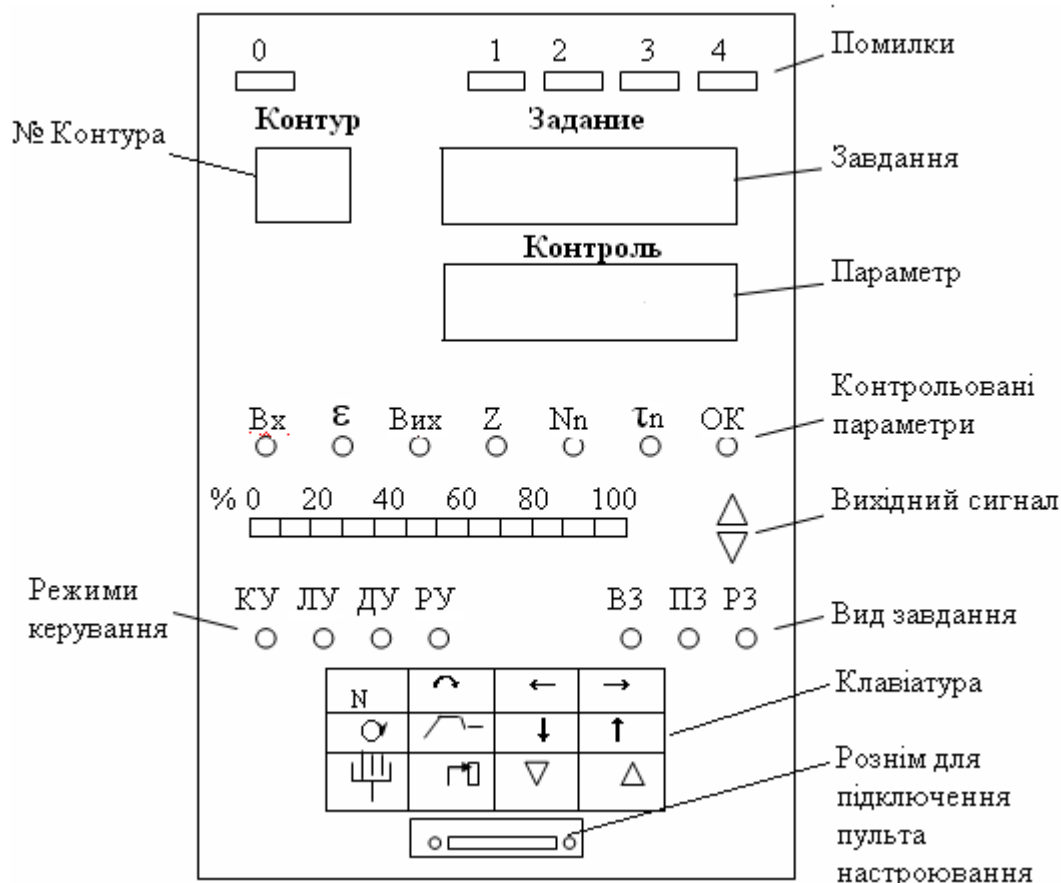
Рисунок 3.2 – Лицева панель ПЛ-1 регулювальної моделі
