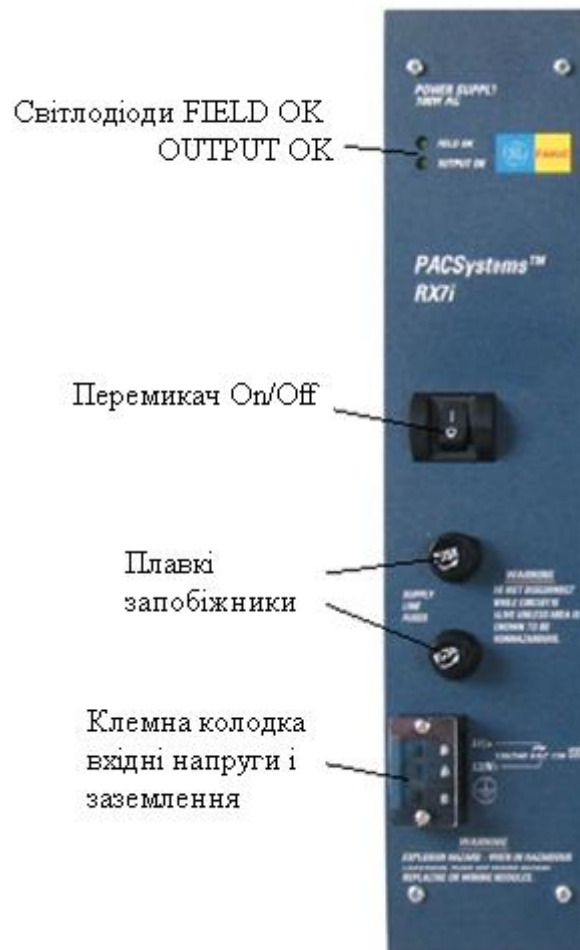
Рисунок 11.5 – Блок живлення IC698PSA100
