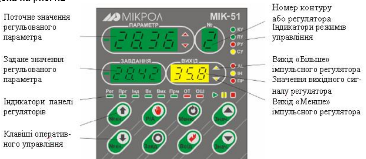
Рисунок 4.2 – Лицева панель МІК-51 в режимі оперативного управління
