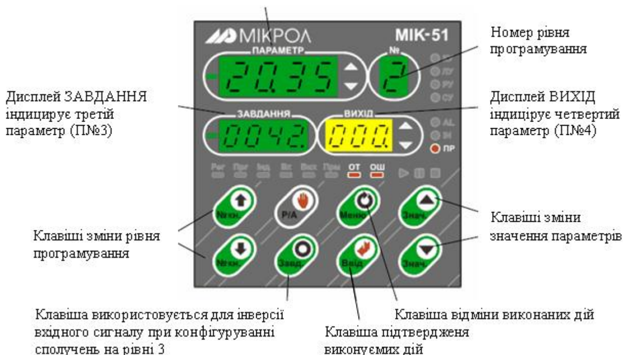
Рисунок 4.6 – Лицева панель контролера МІК-51 у режимі програмування
