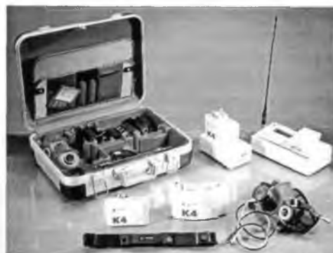
Рис. 42.48. Миниатюрная система для исследования аэробной функции у спортсменов фирмы «Cosmed»
