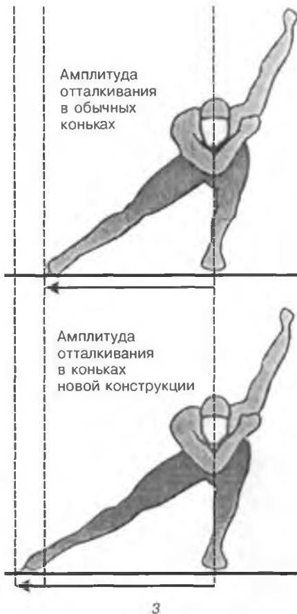
Рис. 42.11. Конструктивные особенности и преимущества новых коньков в конькобежном спорте: 1 — конструктивные особенности коньков; 2, 3 — увеличение амплитуды отталкивания
