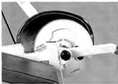
Рис. 42.33. Смещение профиля сопротивления на тренажере фирмы «Субех» при использовании ручного регулятора амплитуды движения (1) по отношению к кривой сопротивления, запрограммированной конструкцией эксцентрического диска (2)
