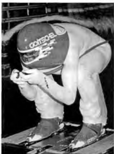
Рис. 42.13. Исследование обтекаемости тела горнолыжника в аэродинамической трубе
