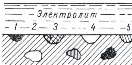
Рисунок 3 – Схема п'ятиелектродного корозійного гальванічного елемента
