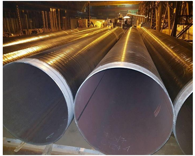
Труби сталеві з оцинкованим внутрішнім покриттям
