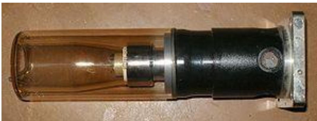
Рисунок 1.10 — Сучасна рентгенівська трубка для рентгеноструктурних досліджень
