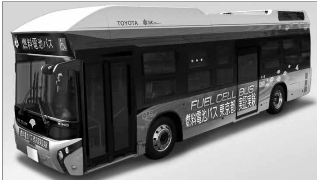
Фото 39. Автобус фірми «Тойота», що працює на водневих паливних елементах. Вихлоп такого автобуса – водяна пара.
