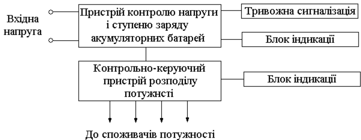
Рисунок 7.4 – Функціональна схема блока керування потужністю
