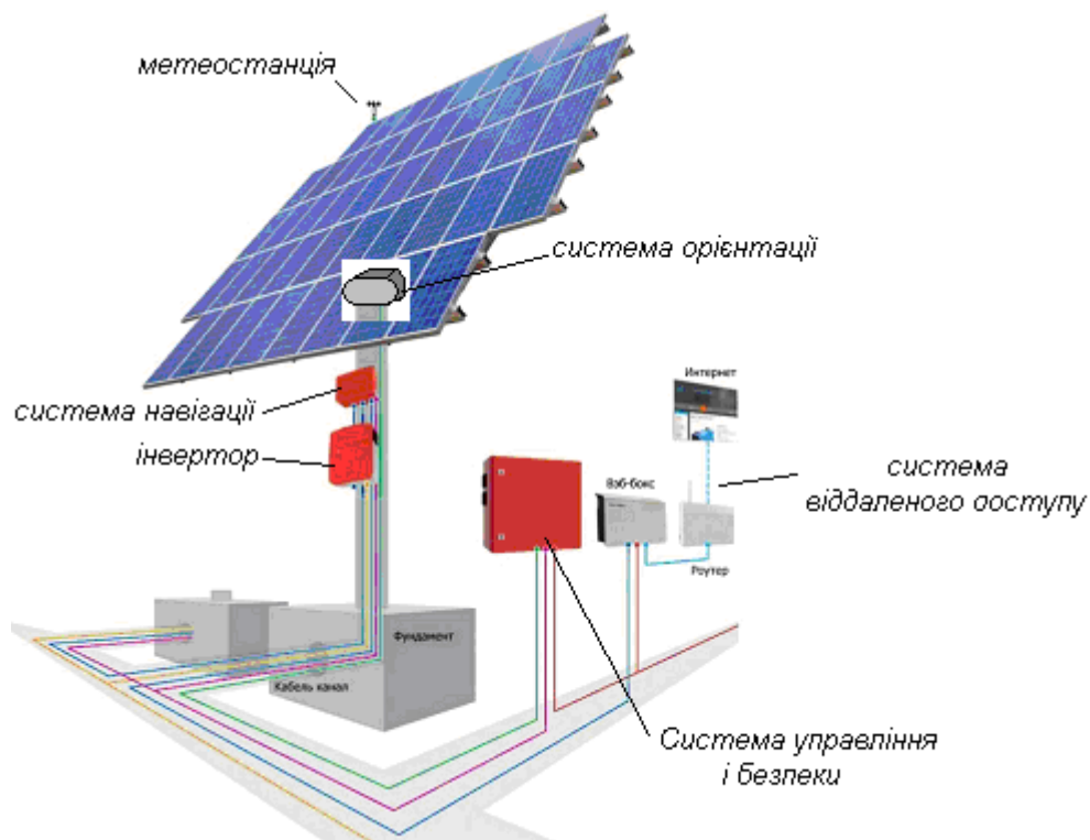
Рисунок 5.2 – Повна комплектація стандартного сонячного трекера
